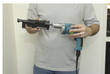
5. Engate o carregador no mandril e fixe-o ao adaptador.
