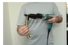
6. Insira a fila de parafusos, com a ponta virada para cima: a sua aparafusadora está pronta!
