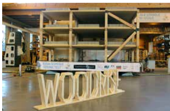
Ensaio sísmico por ocasião da Woodrise 2017
