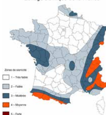
Zonage sismique de la France
