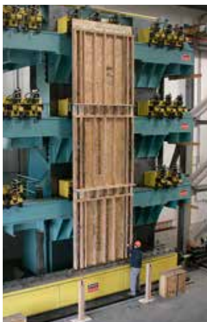
Teste a um imóvel de três pisos à escala 1. Laboratório Simpson Strong-Tie – T.GILB Stockton
