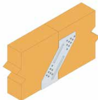
Suporte cantilever SCR instalado com CSA
