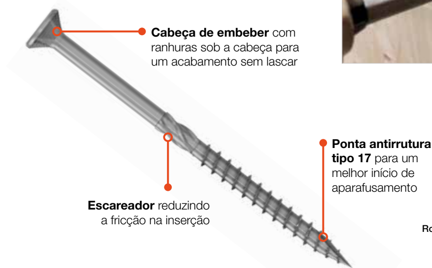
Acessório fixo com parafusos TTZNFS
