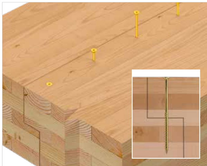
Parafusos SWC utilizados para uma junção meia-madeira
