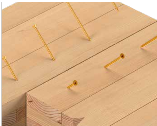
Montagem de plataforma CLT com parafusos ESCRFTC cruzados
