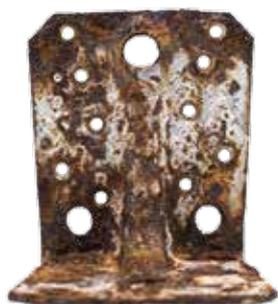
Conector de aço pré-galvanizado Z275
