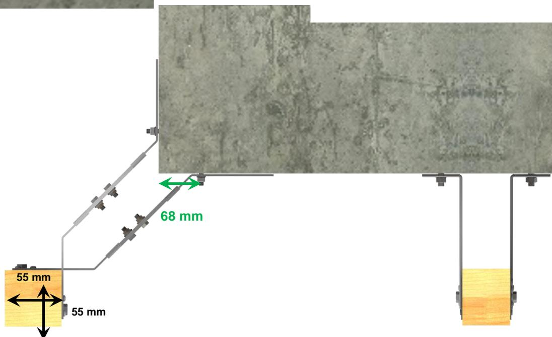
Caso o perno seja fixado a **68 mm** do ângulo da parede, isso obriga a uma secção da trave mínima de **55 x 55 mm**.
