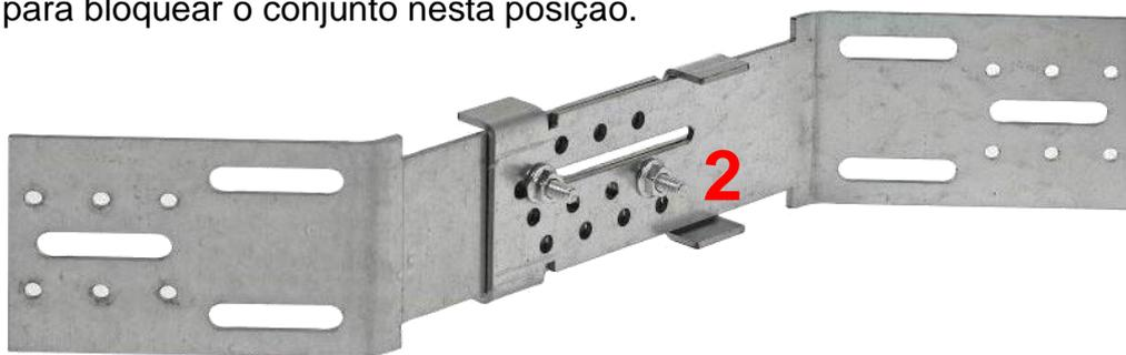
Os furos de bloqueio oferecem **17 níveis de regulação**, o que permite ajustar o esquadro de **4 mm em 4 mm**, de acordo com a espessura do isolante.
