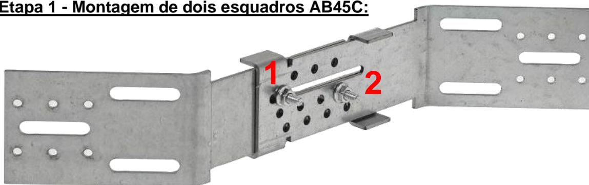
**1** A primeira fixação no furo oblongo mantém os dois esquadros juntos. Esta permite igualmente proceder à regulação de acordo com a espessura do isolante e a secção da trave.
